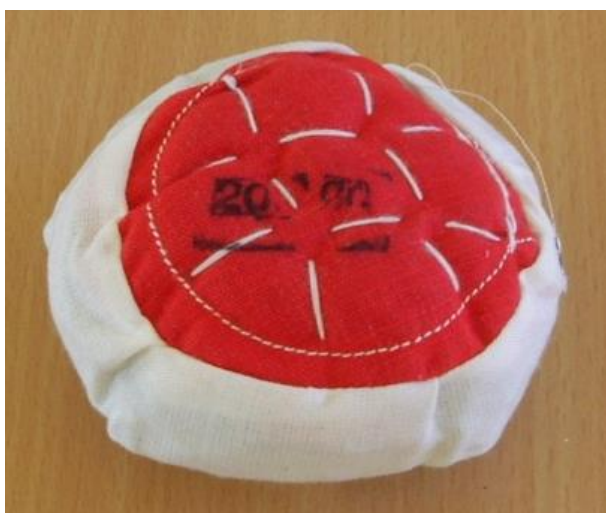
Fig. 9. Kruttpose til Kongsberg hvalkanoner. Foto: EO Øen
