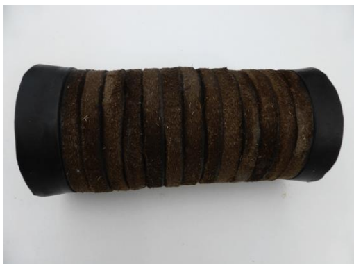
Fig. 14 og 15. Forladning til 90 mm Kongsberg hvalkanon. Foto: EO Øen
