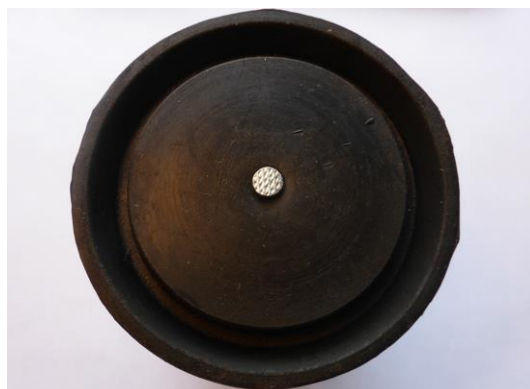
Fig. 14 og 15. Forladning til 90 mm Kongsberg hvalkanon. Foto: EO Øen
