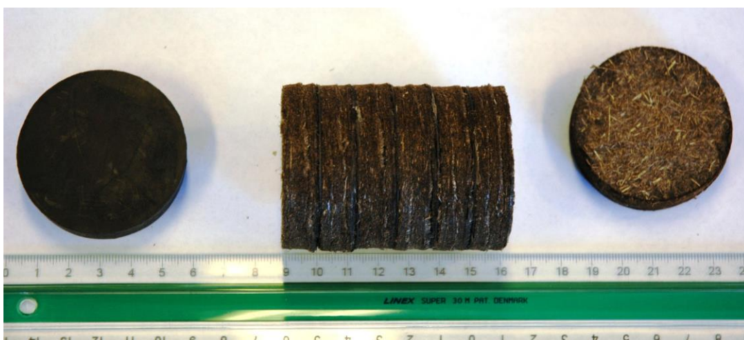
Fig. 10. Forladning med gummipakninger. Foto: Nette Levermann
