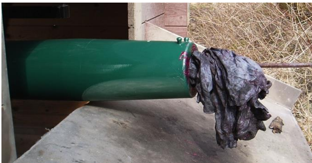
Fig. 19. Rengjøring av løpet på hvalkanon. (Fra prøveskyting av hvalgranater). Foto: EO Øen
