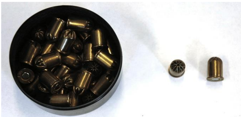
Fig. 8. Eksempel på tennhette/tennpatron (11mm) til 50 mm Kongsberg hvalkanonhylse. Foto: Nette Levermann
