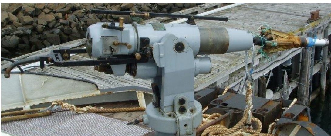
Fig. 3. 90 mm Kongsberg hvalkanon med harpun og modifisert Hvalgranat-99 klar til skudd. Foto: EO Øen
