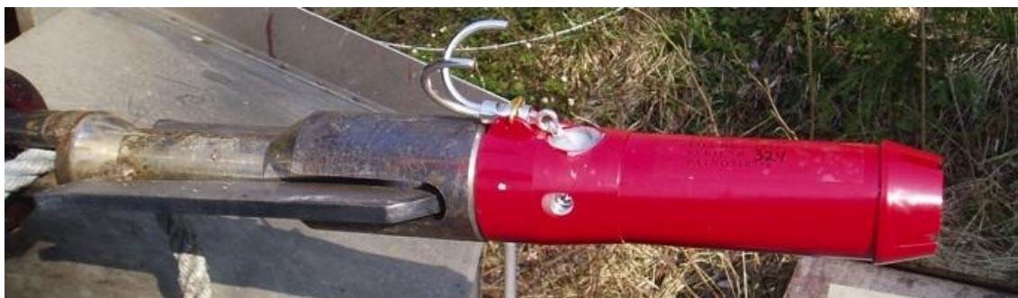
Fig. 27. Hvalgranat-99 med avtrekkerkrok. (Fra prøveskyting av hvalgranater). Foto: EO Øen
