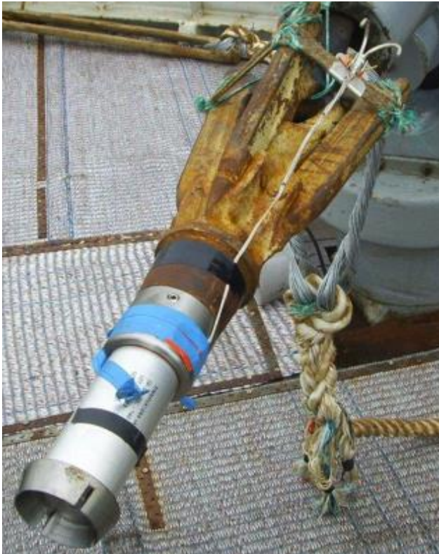
Fig. 18. 90 mm Kongsberg hvalkanon med harpun og modifisert Hvalgranat-99 til storhval. Avtrekkerkrok er festet i bendslingen på harpunen. Foto: EO Øen
