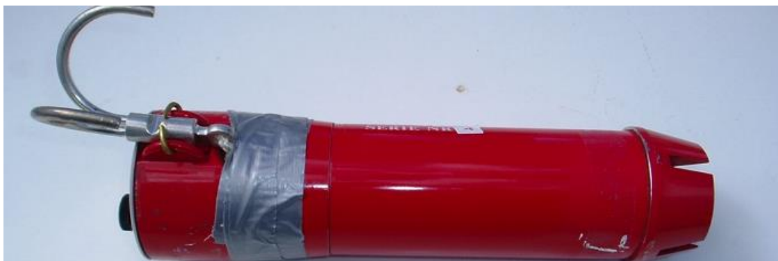
Fig. 29. Hvalgranat-99 der løs avtrekkersnor er lagt tilbake i plastkoppen og teipet fast. Foto: EO Øen
